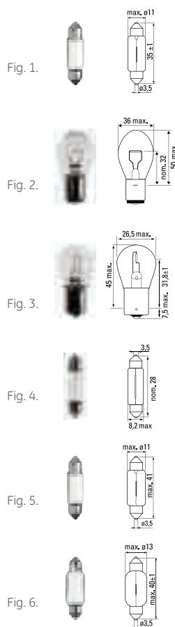
Лампы стоп-сигналов, указателей поворота, габаритных огней и заднего хода
